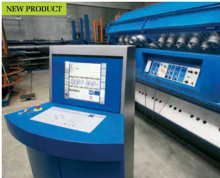
Automatische Richtwerke, Steuerpult und separate PC-Steuerung
