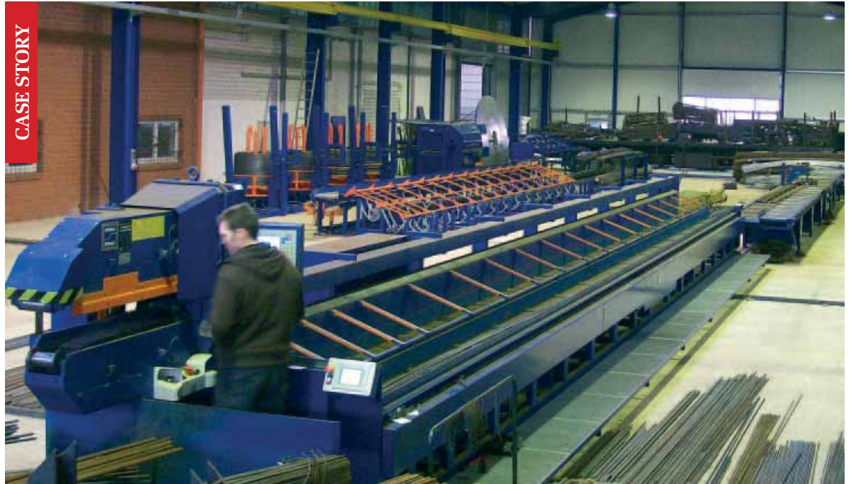
Die neue Halle von Richter mit Stangenschneider Metax Geco.
