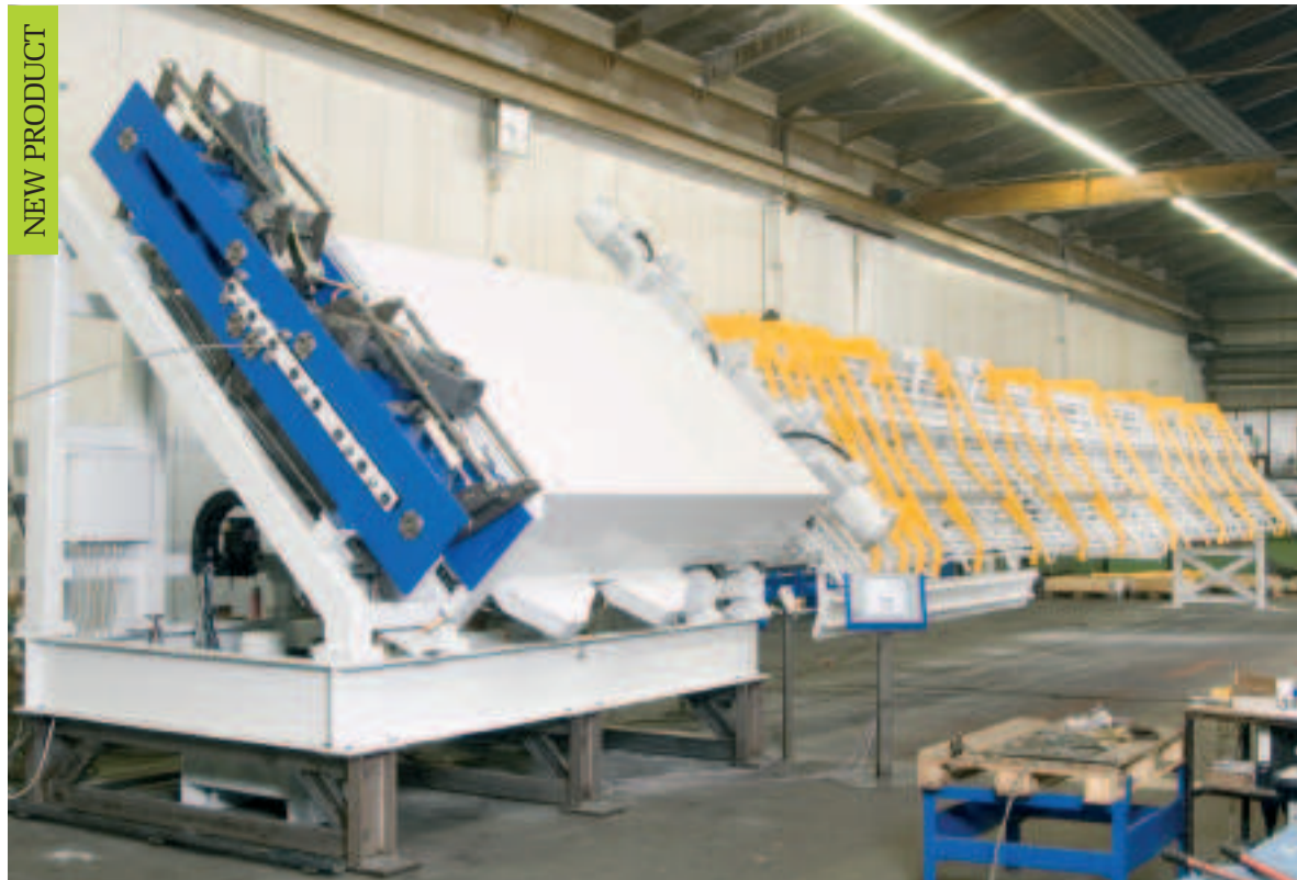
Automatische Richtanlage Rectormatic mit 8 Rotoren
