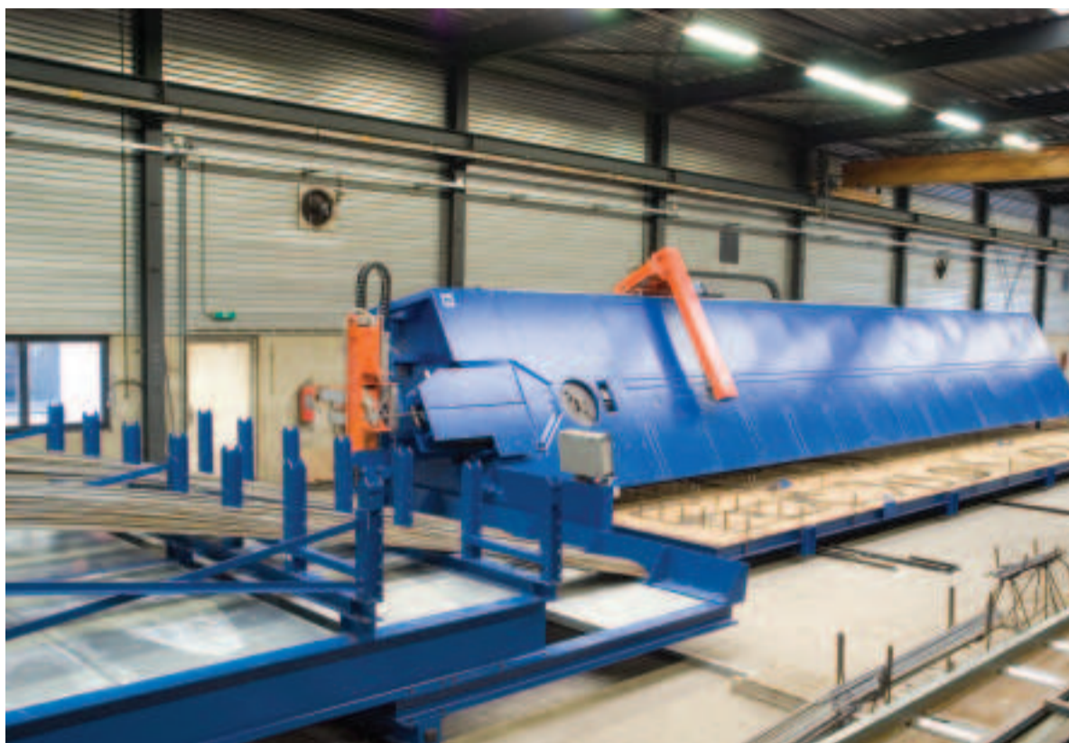
Metamatic Bearbeitungszentrum für Stabdurchmesser bis 32 mm
